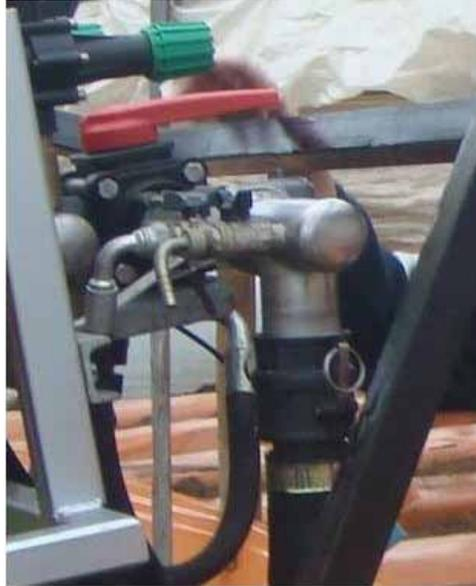
**Figura 12:** Válvulas del sistema de aplicación de aire.
