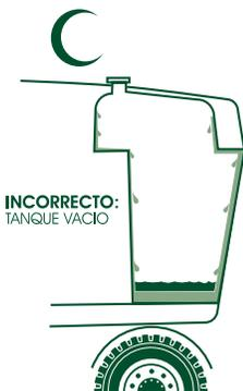
3. SI SE LLENA EL TANQUE DESUÉS DE DETENER LA MÁQUINA, NO HAY ESPACIO PARA EL AIRE HUMEDO
