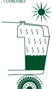
2. AL ENFRIARSE EL AIRE LA HUMEDAD SE CONDENSA EN LAS PAREDES DEL TANQUE Y DESCENDE AL COMBUSTIBLE
