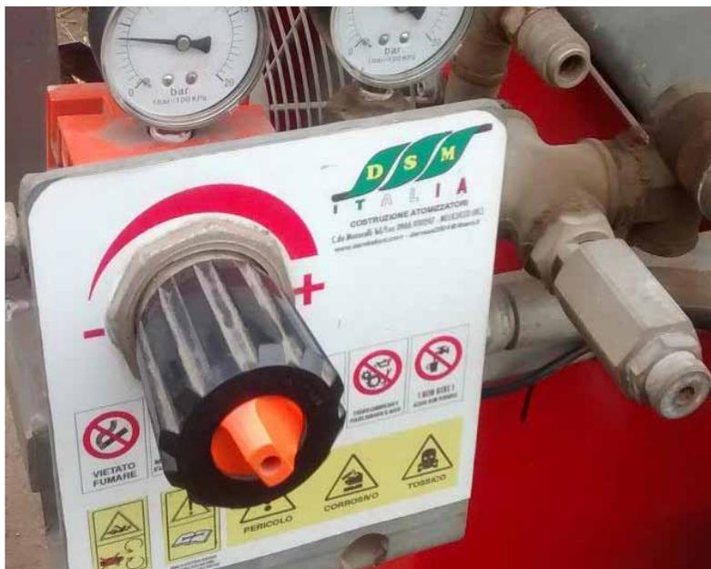
Figura 11. Regulación de los manómetros del aire comprimido.
