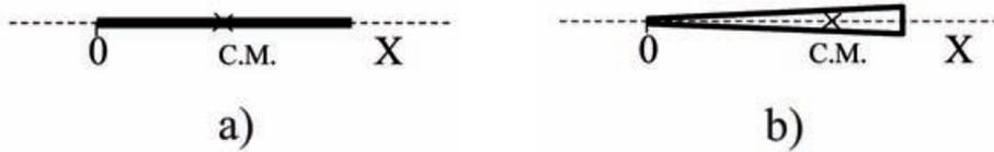
**Fig 2.24.** Varilla unidimensional: (a) de densidad uniforme, (b) de densidad proporcional a la distancia a uno de sus extremos.
