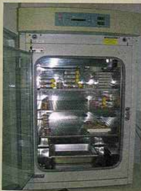
Incubador automático de \text{CO}_2 para cultivo de células, con filtros para aire, control de temperatura, humedad y de presión de \text{CO}_2 . En su interior se puede observar, sobre los estantes, las cápsulas y las botellas de cultivo que contienen el "medio de cultivo" necesario para que las células puedan vivir y proliferar.
