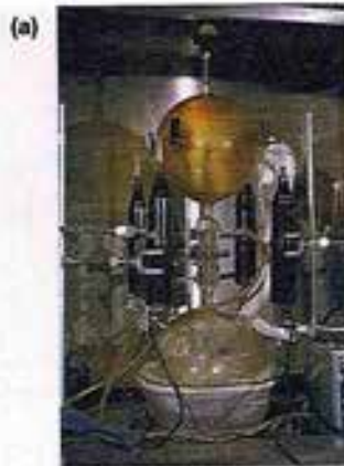
Fig. 1-5. EXPERIMENTO DE MILLER. (a) Fotografía y (b) esquema del experimento. Miller simuló en el laboratorio las condiciones que habrían imperado en la Tierra primitiva. Hizo circular el gas hidrógeno ( \text{H}_2 ), el vapor de agua, el metano ( \text{CH}_4 ) y el amoníaco ( \text{NH}_3 ) permanentemente entre el "océano" y la "atmósfera" de su dispositivo. El "océano" se calentaba, el agua se evaporaba y pasaba a la "atmósfera", donde se producían descargas eléctricas. El vapor de agua, al ser refrigerado, se condensaba y el agua líquida arrastraba las moléculas orgánicas recién formadas. Estas moléculas se concentraban en la parte del tubo que conducía al "océano". Al cabo de 24 horas, cerca de la mitad del carbono presente originalmente como metano se había convertido en aminododécidos y otras moléculas orgánicas. Ésta fue la primera evidencia experimental de la teoría de Oparin.
