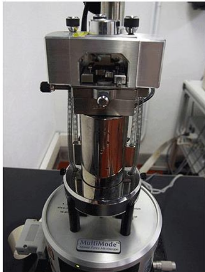
Figura 7. Microscopio de fuerza atómica. Tomado de Nano y micro-partículas en materiales multicomponentes.
