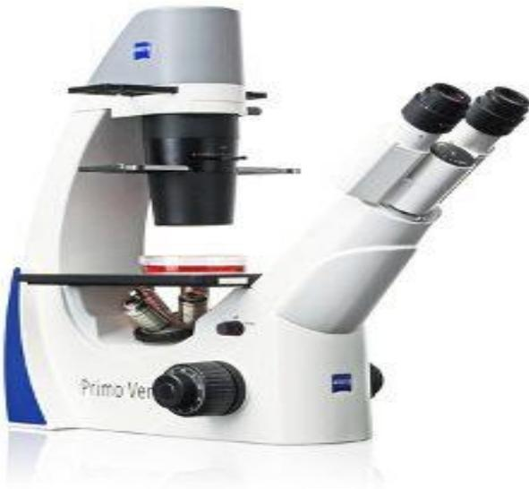
Microscopio invertido (Fuente: Zeiss Microscopy)
