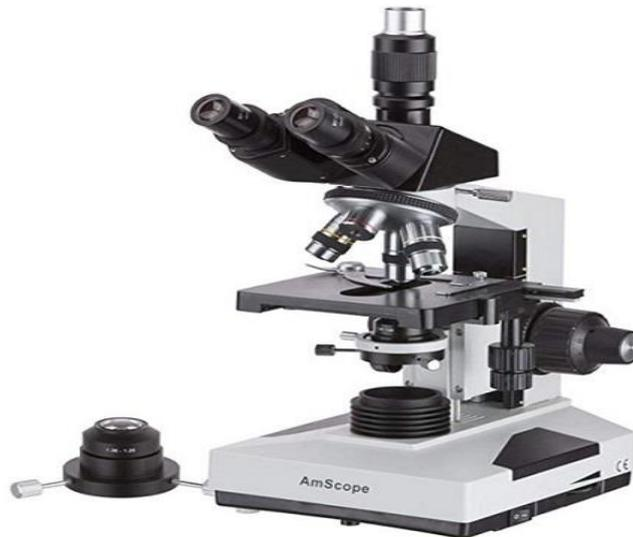
El microscopio de campo oscuro es un instrumento óptico especial utilizado en ciertos laboratorios. Este es el resultado de una modificación realizada a la microscopía de campo claro. La microscopía de campo oscuro se puede lograr por trans-iluminación o por epi-iluminación.
