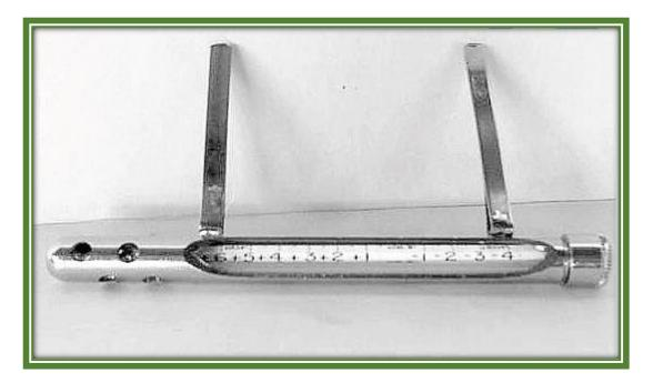
**Tensiómetro.** Es un dispositivo que se coloca en el extremo de la cinta para asegurar que la tensión aplicada a la cinta sea igual a la tensión de calibración, evitando de esta manera la corrección por tensión y por catenaria de la distancia medida.
