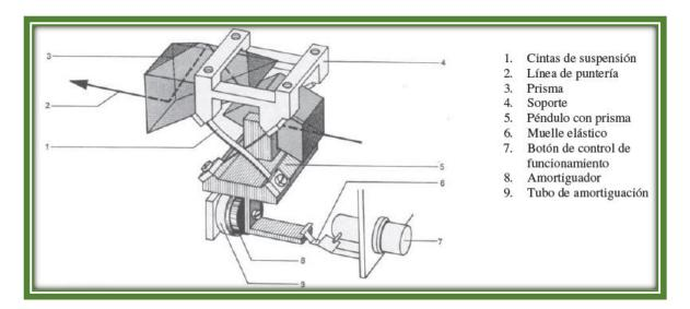
Algunos niveles automáticos más sofisticados, poseen un compensador óptico mecánico a fin de garantizar la puesta en horizontal del eje de colimación. Existen también niveles automáticos con compensador de amortiguación magnética. Se muestra el nivel automático C40 de Sokkisha y el esquema de funcionamiento del compensador de amortiguación magnética.
